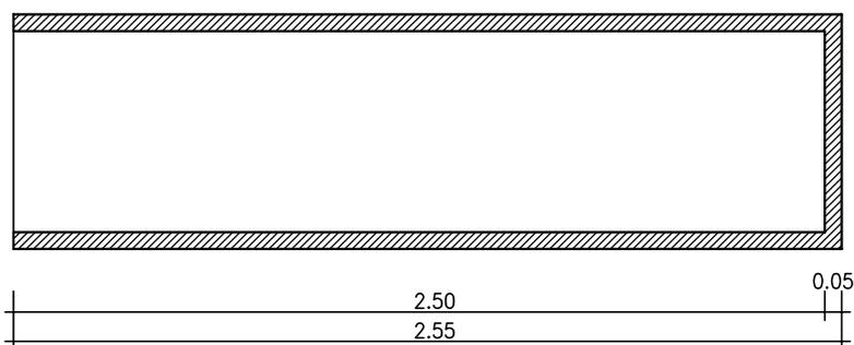
nell'assemblaggio in file e colonne occorre tener conto delle tolleranze dimensionali e dell'accostamento orizzontale e verticale secondo le seguenti indicazioni:
