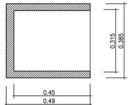
nell'assemblaggio in file e colonne occorre tener conto delle tolleranze dimensionali e dell'accostamento orizzontale e verticale secondo le seguenti indicazioni:
